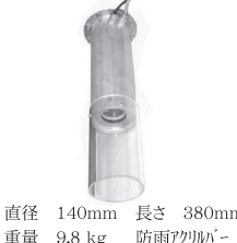
光学22倍×デジタル10倍 (50m下方の新聞の見出しが読めます)
